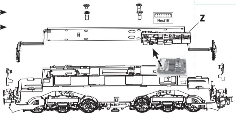
**SCHRAUBEN ENTFERNEN UND PLATINE ABLÖSEN**
